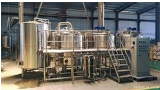
Maische-, Läuterbottich, Whirlpool und Heisswassertank mit unterschiedlicher Aufstellung, Anordnung für den Brauprozess individuell-optimal konzipiert.
