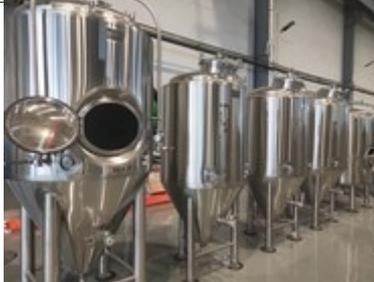
**Gär- und Lagertanks** in unterschiedlichster Grösse und Ausführung. In Edelstahl gefertigt (bereits ab 250lt bis 5'000lt Volumen).
