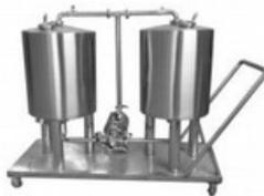
**Kompakte fahrbare CIP Reinigungswagen**, mit Steuerung für Heizung (Lauge), Füllstandsüberwachung.
