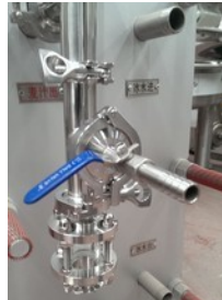
Würzschauflas mit z.Bsp. Sauerstoffzufuhr
