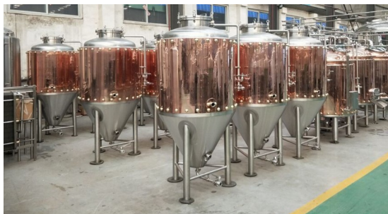
Spezialausführung auch mit Kupfermantel u.a. mit Mantel- und Konuskühlung
