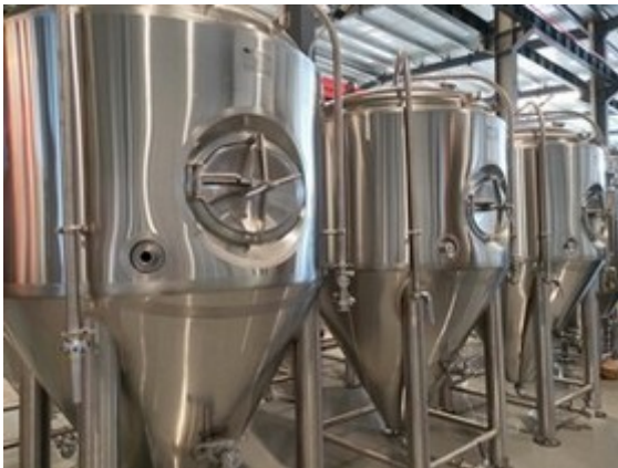
Zylinderkonische Gärtanks ab 200lt bis 10'000lt
