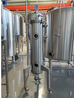
Bsp. Hopgun , mit bierschonender Membranpumpe
