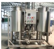
CiP Reinigungsstation 2-fach Behälter
