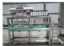
8-fach Flaschenfüller lineare Funktion
