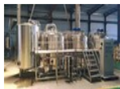
3-Gerätesudhaus 500l mit Heisswassertank
