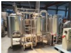
2-Gerätesudhaus 300l mit Heisswassertank
